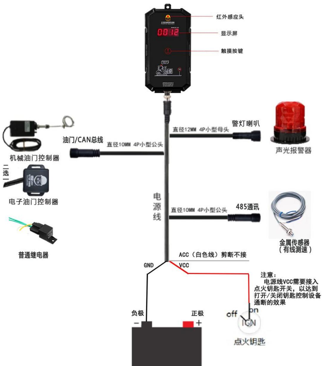
备注：产品安装前，请按照产品电气连接图先通电测试基本功能，确认无误后再进行固定安装，以达到安装效率最大化。
