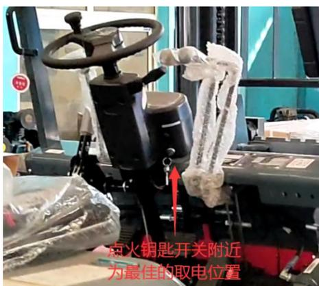
可直接在点火钥匙开关附近取电
